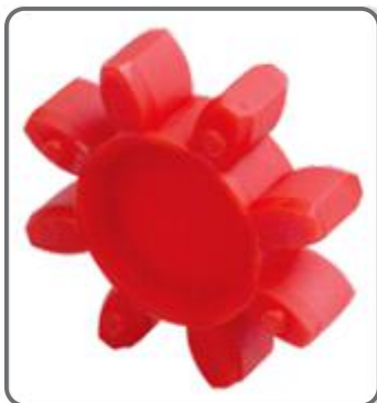
Elastómero: 98 / sh A Rango de temp -30 ~ + 120°C
